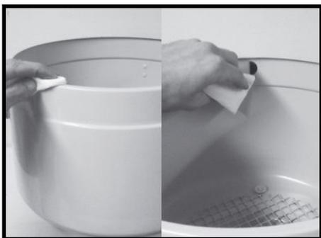
**Passo 4.** Limpar a área onde a parte superior e inferior da caixa se juntam e limpar o orifício de drenagem.
