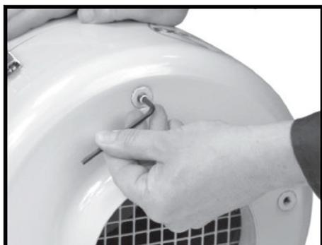
**Passo 1.** Retire os quatro parafusos de inserção na base da unidade.
