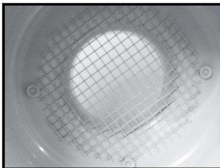
**Passo 17.** Verificar se a grelha de entrada de ar está desobstruída.
