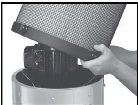
**Passo 4.** Verificar o pós-filtro (se instalado) e substituí-lo se necessário.
