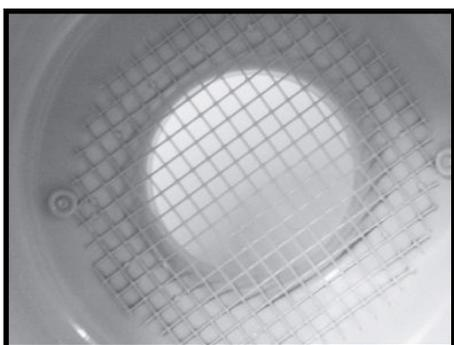
**Passo 8.** Verificar se a grelha de entrada de ar está desobstruída.
