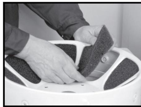
**Passo 12.** Retirar o silenciador antigo e montar o novo silenciador.
