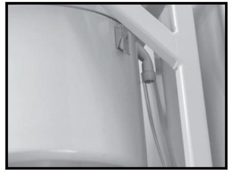
**Passo 6.** Ligar a entrada da unidade ao orifício de extração utilizando uma conduta e um adaptador adequados (fornecidos separadamente).
