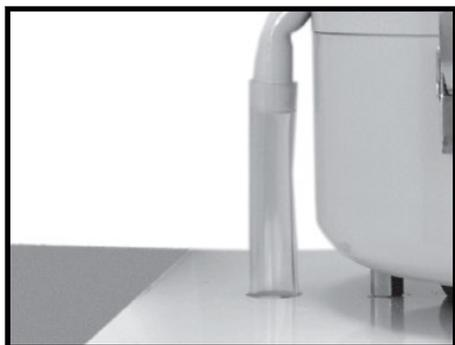
**Passo 4.** Instalar o tubo de retorno do óleo e posicionar o tubo para drenar o óleo de volta para o compartimento da máquina, cárter ou recipiente de recolha.
