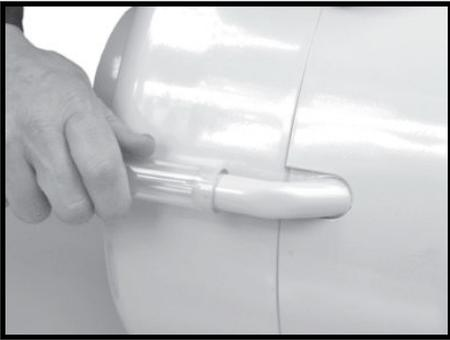
**Passo 7.** Instalar o tubo de retorno do óleo e posicionar o tubo para drenar o óleo de volta para o compartimento da máquina, cárter ou recipiente de recolha.
